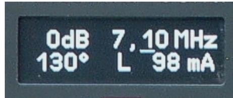
**Achtung!** In der unteren Zeile werden bei Geräten ohne Antennensteuerung (Version RAP1A/C) nur der WiFi-Verbindungsstatus (hier „L“ für verbunden mit Access Point) und die 1 mA-Stelle der Stromanzeige (immer 0, da keine Speisung von Antennen möglich) angezeigt!
