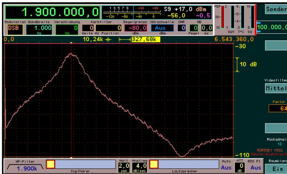
Einstellung 1,9 MHz: Die Filterkurve (Ende 1. Bereich, unterkritische Kopplung) wird im höherfrequenten Bereich durch ein zusätzliches Notchfilter versteilert und ist daher in linearer Frequenzdarstellung nahezu symmetrisch.
